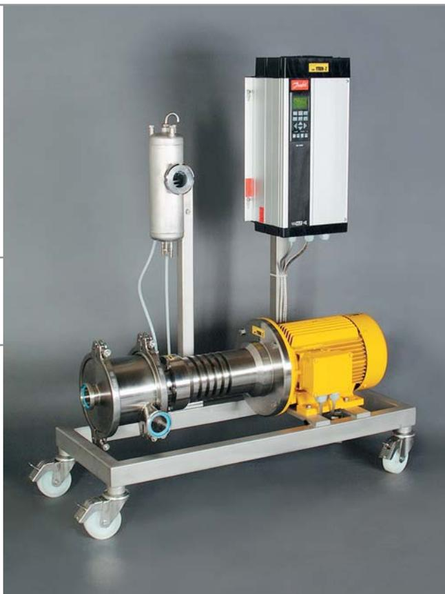
YTRON-Z móvil con variador de frecuencia
