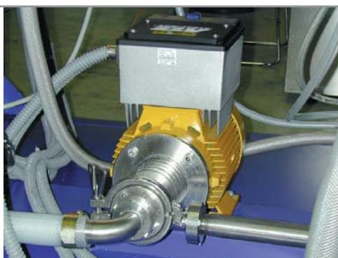
YTRON-Z con convertidor variador de frecuencia
