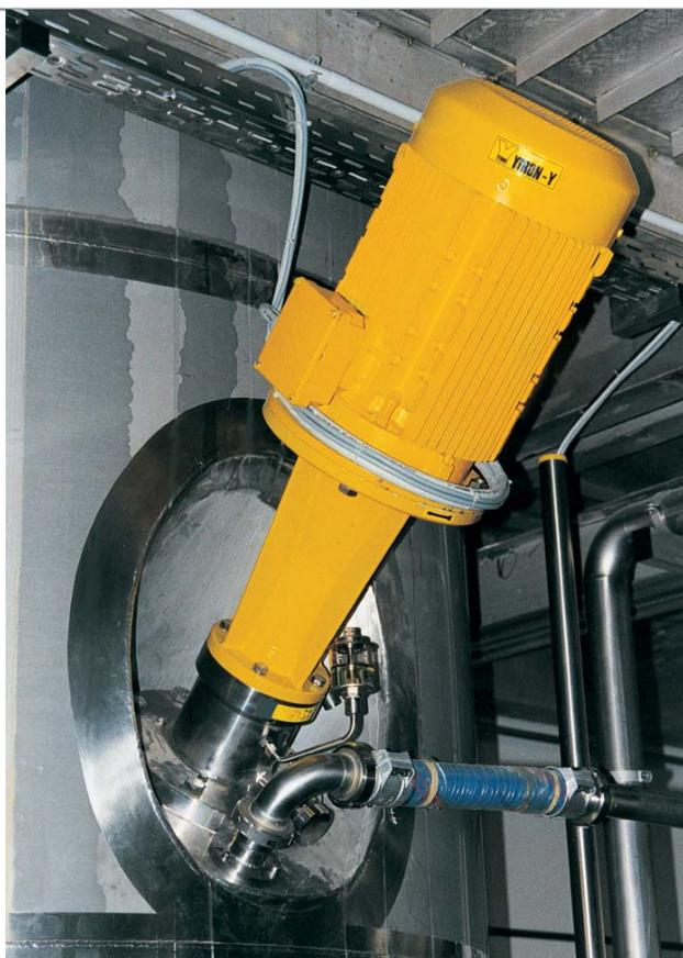
YTRON-Y ByPass en versión de entrada lateral en tanque, montaje en depósito cerrado
