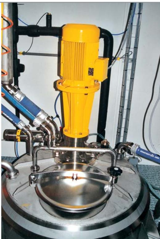
YTRON -Y en versión de brida del tanque, montaje
