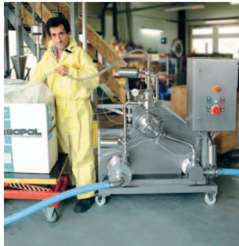
YTRON-PID en una construcción móvil; Incorporación libre de un polímero acrílico
