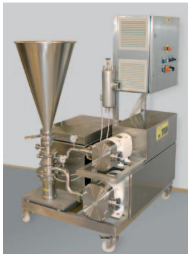
YTRON-ZC ViscoTron para viscosidades elevadas
