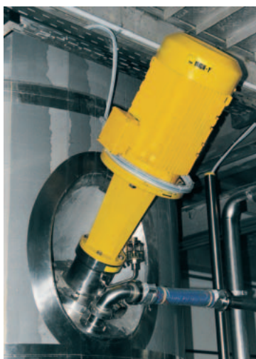
Montaje de entrada lateral bajo el nivel de líquido, CIP, ByPass
