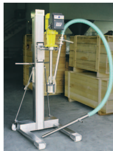
YTRON-Y con ByPass montado sobre una columna móvil
