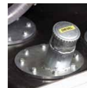
180 liter PE diesel reservoir.
