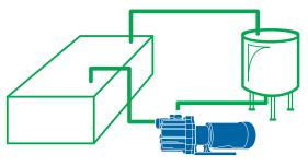
4 Bombeo desde la superficie del tanque de acabado mediante filtros.
